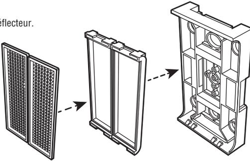
2. Faire glisser le capteur photoélectrique et le réflecteur sur les supports de montage et les fixer avec les vis autotaraudeuses fournies à cet effet.
